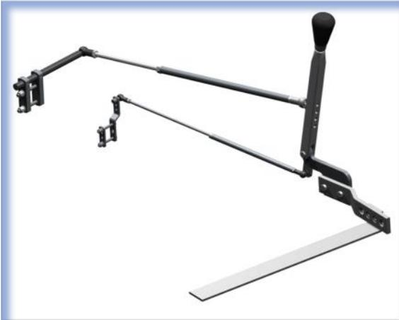
Proyecto realizado el año 2010. Dispositivos de acelerador y freno mecánico de palanca tipo vertical, uno con palanca recta y otro con palanca orientable.
