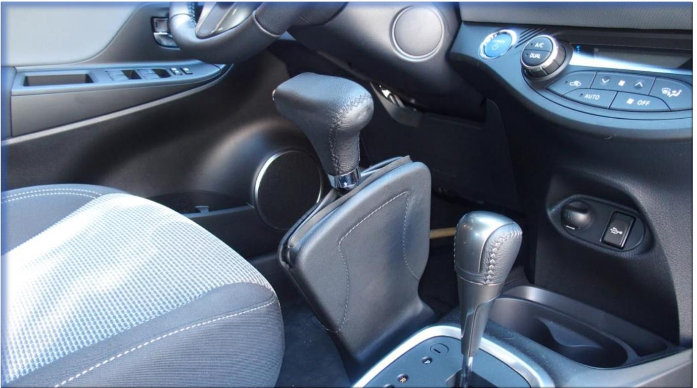
Proyecto realizado el año 2016. Dispositivo freno mecánico de tipo palanca vertical y acelerador electrónico.
