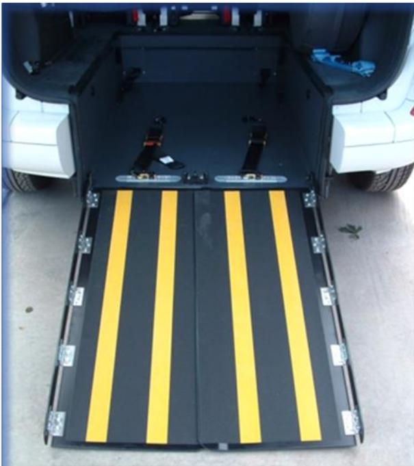
Rebaje de piso más rampa doble hoja desmontable, comercialmente llamado "Eclipse". Proyecto realizado en el año 2003. Transformación de rebaje de suelo sobre vehículos Citroën C8, Fiat Ulysse y Peugeot 807 destinado principalmente al servicio de taxi adaptado. Sistema totalmente novedoso del cual se emitió una patente de invención.
