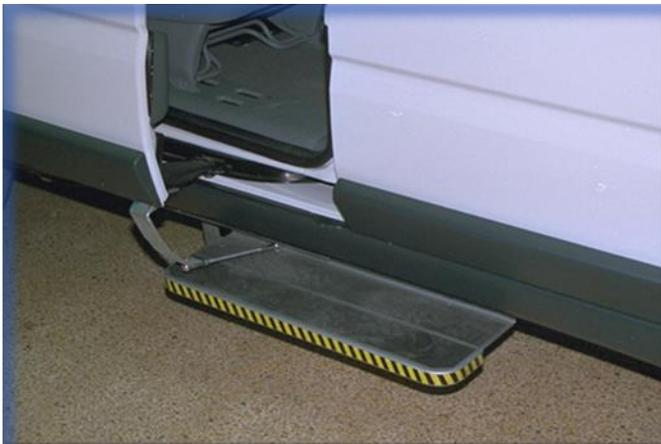
Proyecto realizado el año 2003. Escalón lateral giratorio electrónico para transformados de vehículos.
