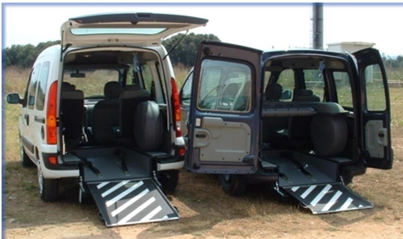
Proyecto realizado el año 2001. Transformación de rebaje de suelo sobre vehículo Renault Kangoo, sistema manual y sistema con compresión de suspensión hidráulica.
