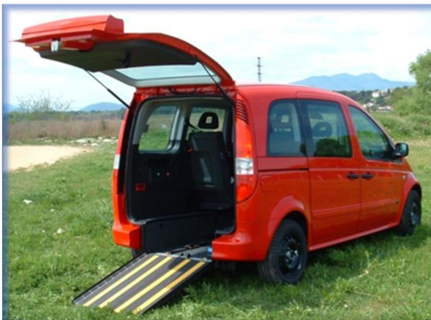
Proyecto realizado el año 2003. Transformación de rebaje de suelo sobre vehículo Mercedes Vaneo, dos versiones de transformación, modelo corto y modelo largo.
