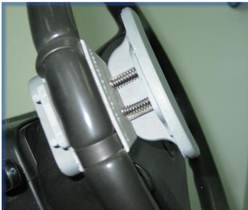
Proyecto realizado durante el año 2007. Dispositivo acelerador y freno electrónico todo en una mano y con colocación en el volante. La novedad representó obtener una patente de invención.
