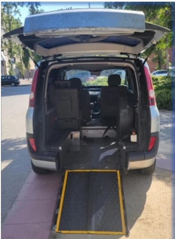
Proyecto realizado durante el año 2003. Transformación de rebaje de suelo sobre vehículos Renault Space . Integración de la plaza de silla de ruedas en segunda fila de asientos. Sistema estructural de transformación tipo monocasco.
