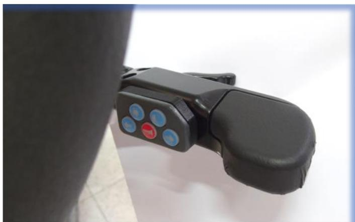
Proyecto realizado el año 2016. Pulsantes para el accionamiento de servicios incorporados en dispositivo de freno y acelerador.
